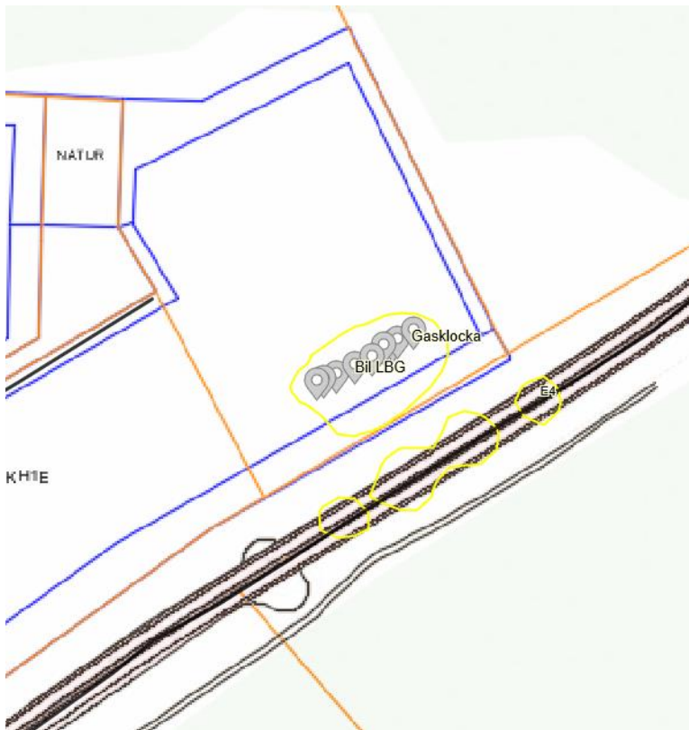
Figur 1. Individriskkontur då samtliga riskkällor placeras så nära E4 som detaljplanen ändras till att tillåta. Gul kontur anger individrisken 10^{-5} . Skärmskott från mjukvaran RISKCURVES.
